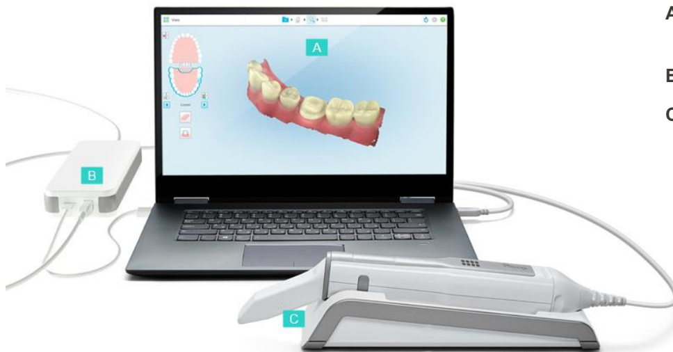
Chiffre 3: iTero Element 5D laptop-configuration système d'imagerie
